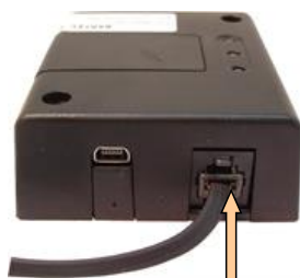
Anschluss für Stromkabel
